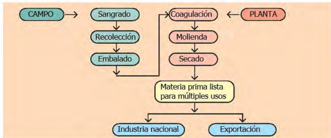
Figura 17. Esquema general del procesamiento del hule
