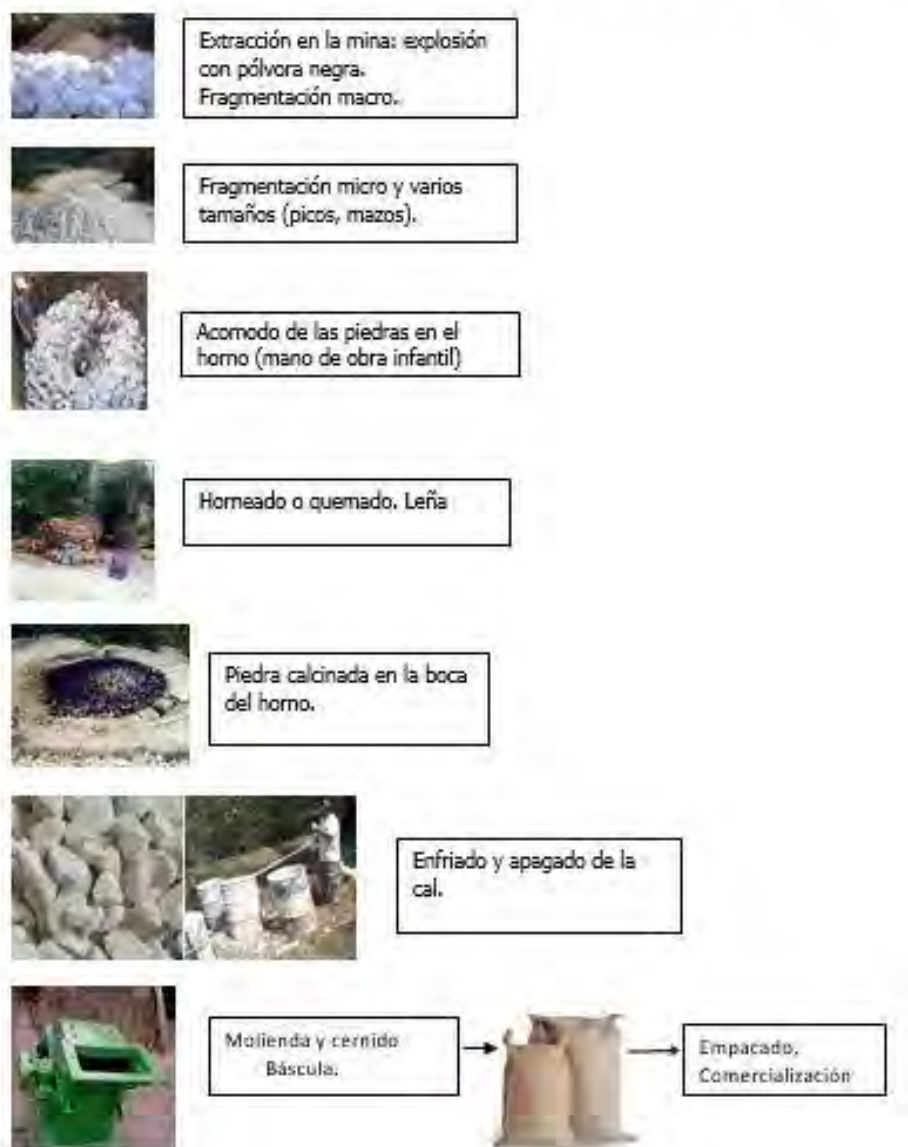
Figura 1. Proceso artesanal de elaboración de la cal en SRS.
